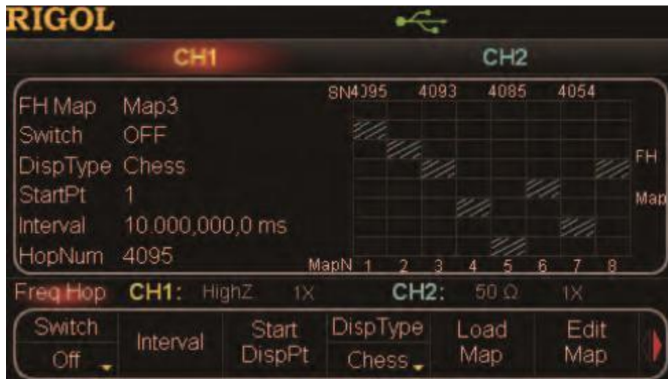
Рис.3.2. – Налаштування та вибір функцій на екрані універсального генератора сигналів Rigol DG5102 [20]
