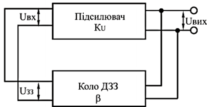
Рис.1.7 – Структурна схема генератора синусоїдальних коливань [8]
